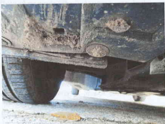
Fot. nr 9.17. Podwozie: LT /ogniska korozji/.
