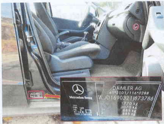
Fot. nr 9.13. Widok umieszczenia tabliczki znamionowej i wklejka TZ.
