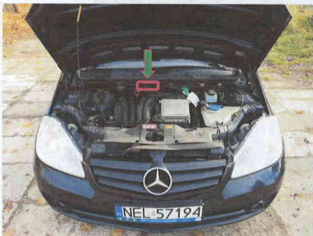
Fot. nr 8.1. Widok miejsca identyfikacji – trwale wybity numer VIN.
