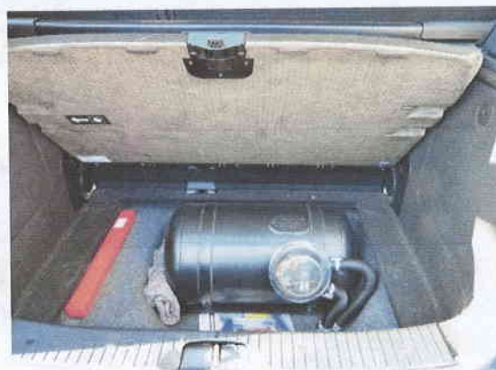
Fot. nr 9.16. W bagażniku instalacja gazowa LPG.
