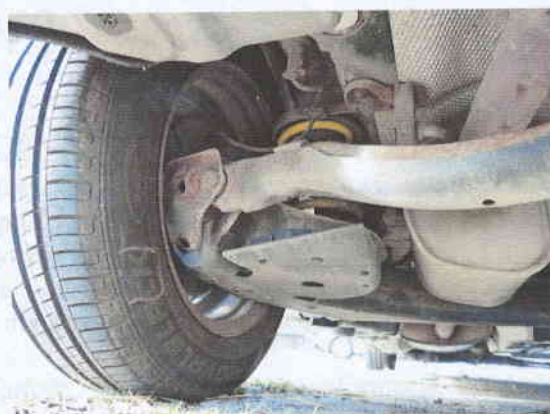
Fot. nr 9.18. Podwozie: PP /ogniska korozji/.
