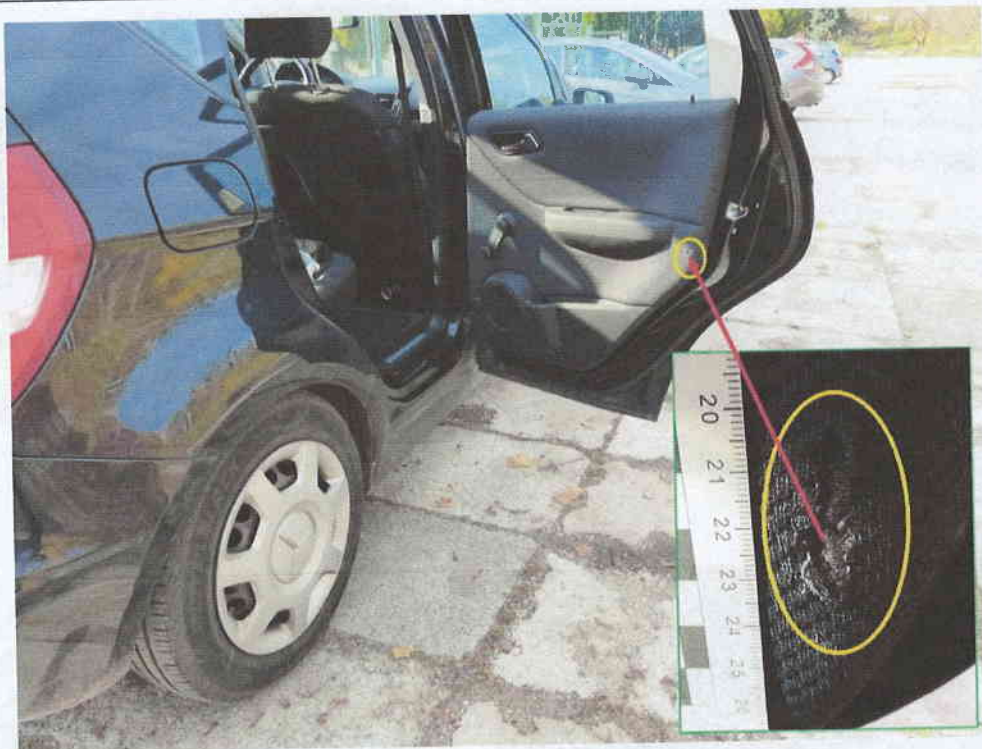
Fot. nr 9.5. Uszkodzenia: tapicerka drzwi PT.
